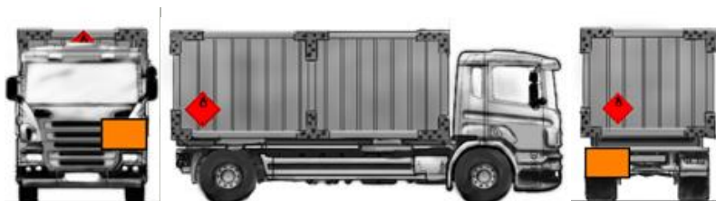
Obrázek 2 Příklad označení vozidla při přepravě nebezpečných věcí v kusech v kontejneru (standardní ADR)
