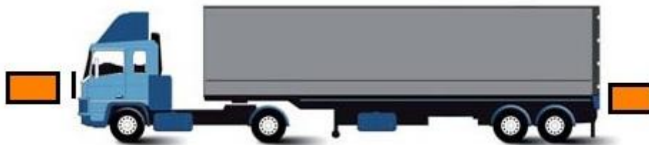
Obrázek 4 Příklad označení vozidla při přepravě nebezpečných věcí v kusech (standardní ADR)
